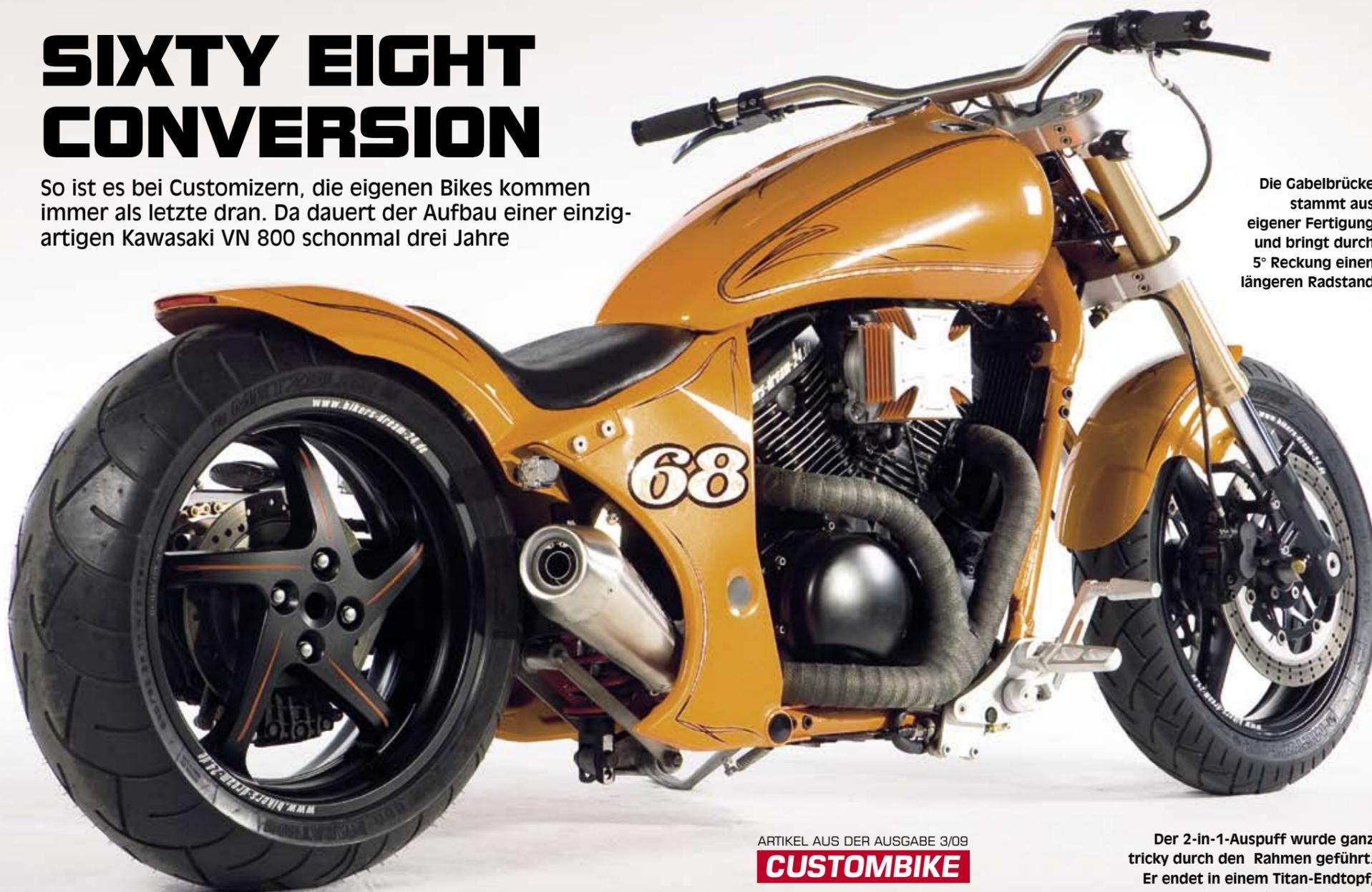
Die Gabelbrücke stammt aus eigener Fertigung und bringt durch 5° Reckung einen längeren Radstand
